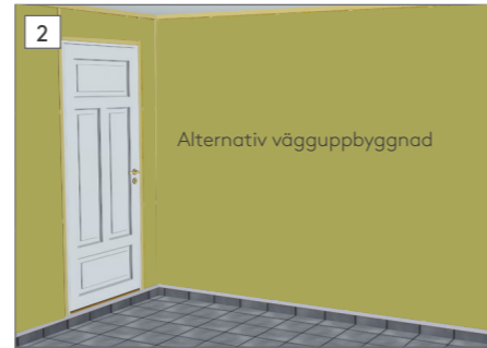
2 För bästa resultat använd minst 12mm byggplywood bakom skivorna. OBS! om klinker ska sättas mot väggen måste en godkänd skiva monteras minst 200mm upp från golvet. Om golvet läggs med våtrumsmatta skall mattan upp minst 150mm på väggen. Se monteringsanvisning för klinker/plastmatta.
