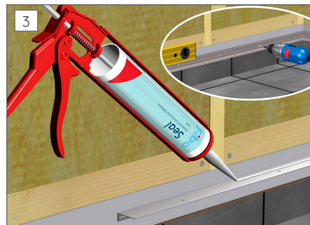
3 I våtrum används en sockellist som monteras minst 60mm från golvet. Alla lister rengörs innan användning med Fibo Clean och Fibo Wipes. Lägg fogmasse på baksidan av listan nedanför skruvhålen och montera listan vågrätt. Se också punkt 18. Detta gäller både för standard invändig hörnlist och den 2-delade invändiga hörnlisten.
