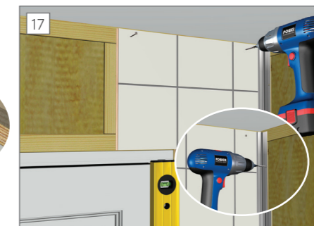
17 Skivorna fästs lodrätt upptill så att skruvarna döljs av taklisten. Lämna minst 5mm rörelsefog upp mot taket
