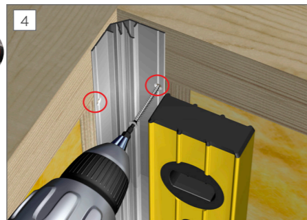
4 All montering sker från vänster till höger. Innerdelen av hörnlisten skruvas fast i bägge underfalsarna. För montering av sockellist se punkt 3.
